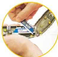
2. Retire uma lâmina do compartimento.
