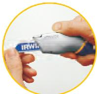
2. Retire a lâmina, vire-a e coloque de volta no estilete. Certifique-se que a lâmina está bem presa.
