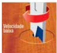
Inicie o furo a uma velocidade baixa e com pressão moderada. A operação contínua e paciente funciona melhor ao furar madeira, evitando o escape da broca, formação de rebarbas e furos desalinhados. Se usar a furadeira em alta rotação, a broca irá superaquecer e danificará o fio de corte.
