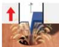
Alívie a pressão sobre a furadeira e a retroceda de tempos em tempos. Esta ação permitirá remover o cavaco do fundo do furo e liberar mais espaço. Uma força excessiva e contínua compactará o cavaco, travando a broca dentro do furo.
